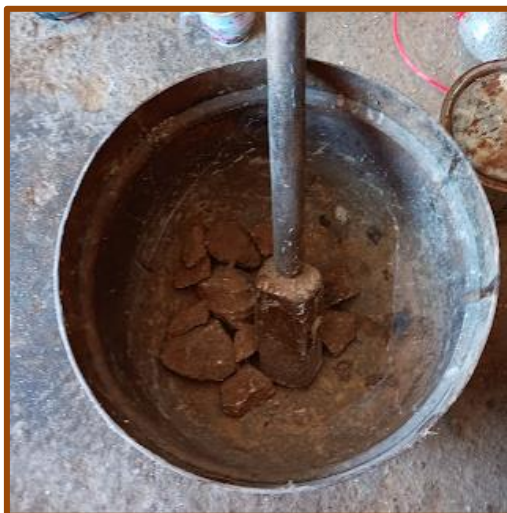
Εικ. 3: Ξύλινο κόπανο, μεταλλικό, μεγάλο γουδί, με μεταλλική απόληξη για θλίψη υλικών.
